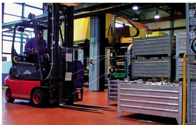
Bild 1: Am Gabelstapler schaltet ein Ultraschall-Abstandssensor (1), der zwischen den Gabelzinken angebracht ist, die RFID-Lesegeräte und damit die beiden UHF-Antennen (2) zum Erfassen der Transponder ein.
