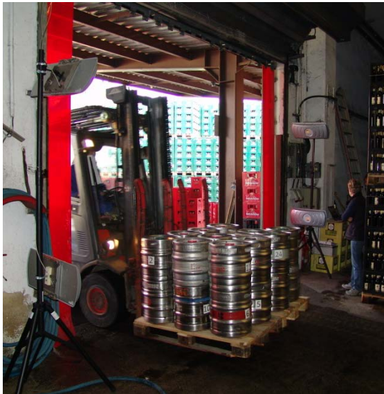
Abbildung 1: Erfassung der KEGs am Wareneingang
